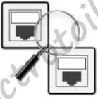
b. En utilisant un testeur réseau, **vérifier** que le repérage des prises RJ45 murales est correct. Pour cela **brancher** le testeur réseau sur une première prise murale RJ45 et l'autre extrémité du testeur sur une prise RJ45 du répartiteur. **Appuyer** sur le bouton test de l'appareil, vous saurez si la liaison est correcte et si le repérage des prises est correct (**Voir** illustration).
